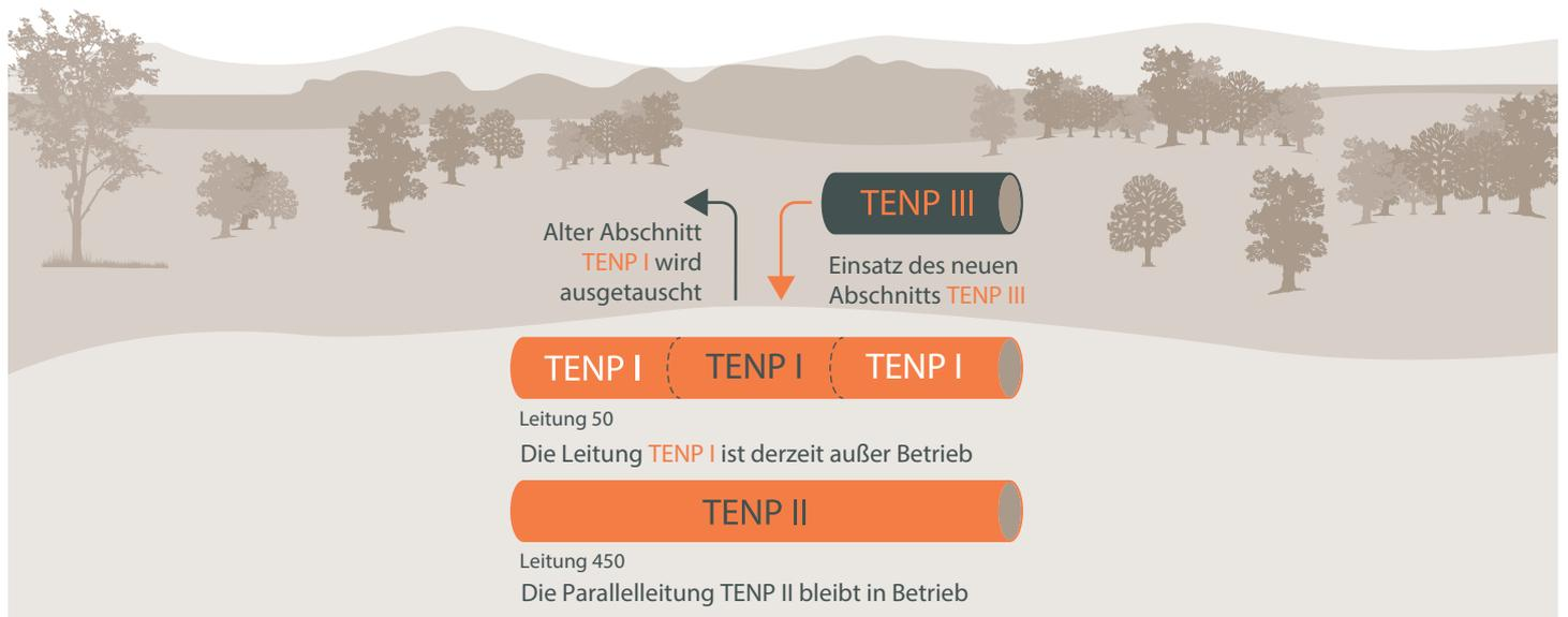
Der Austausch des Leitungsabschnitts erfolgt zu 87 Prozent in gleicher Trasse. Demnach wird zuerst die TENP I-Leitung zurückgebaut. Die neue TENP III-Leitung wird dann anschließend nahezu vollständig in der bestehenden Trasse errichtet.
